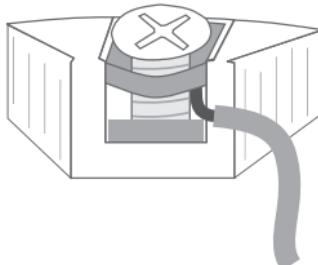
Провод монтируют между пластинами
